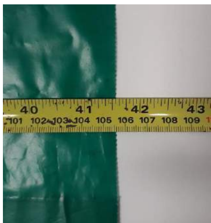
Figura 2. Avaliação Dimensional – Altura.
