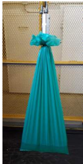
Figura 5. Ensaio de Verificação da Estanqueidade.
