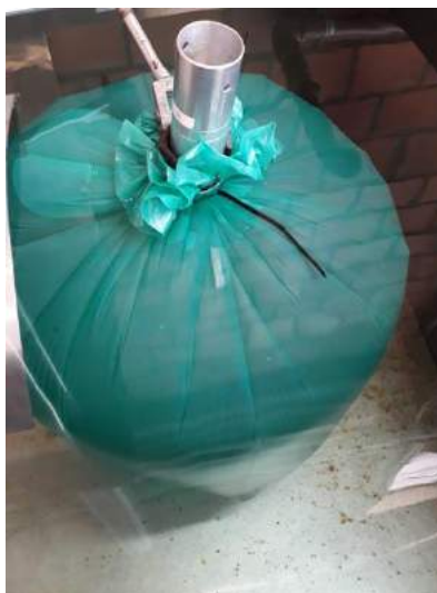
Figura 7. Ensaio de Determinação da Capacidade Volumétrica.
